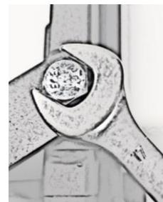
**NL :** Om beschadiging te voorkomen, de montage steeds uitvoeren op de bubbelfolie van de verpakking. Monteren van de poten: de 8 bouten eerst handmatig, recht, indraaien, pas daarna met een sleutel 17 gelijkmatig vastzetten. Met twee personen voorzichtig omdraaien.
