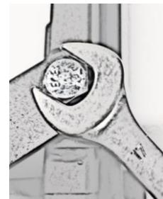
**NL** : Om beschadiging te voorkomen, de montage steeds uitvoeren op de bubbelfolie van de verpakking. Monteren van de poten: de 8 bouten eerst handmatig, recht, indraaien, pas daarna met een sleutel 17 gelijkmataig vastzetten. Met twee personen voorzichtig omdraaien.
